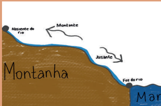
FIGURA 16. Pontos de referência: montante e jusante
