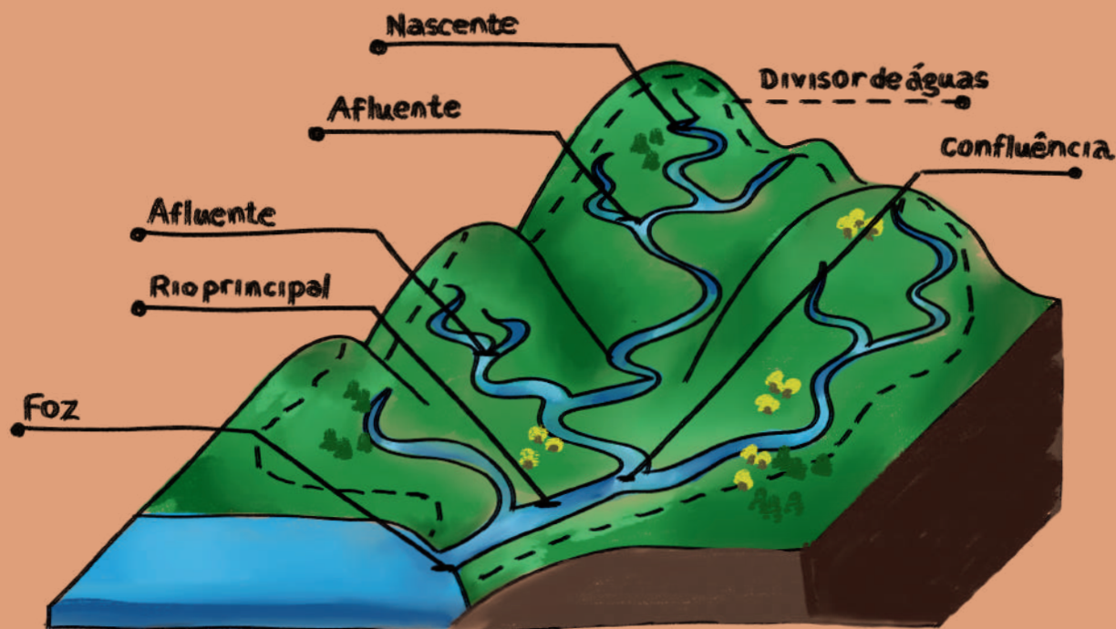
FIGURA 15. Elementos de uma bacia hidrográfica Fonte: ilustração própria baseada em Geografia - Bacia Hidrográfica
